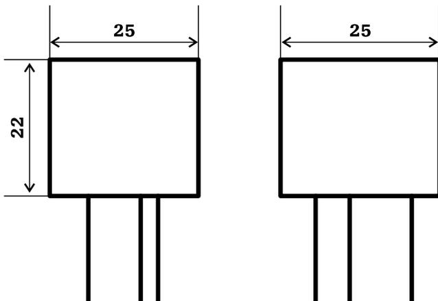
安装方式 直接焊在PCB上
